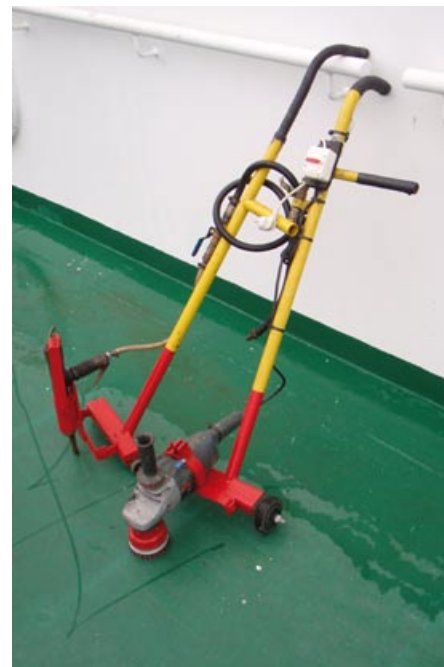
Vagnarna minskar belastning och vibrationer från både nålpistol och slipmaskin.
