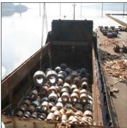
Lossning i Vejle. Rullarna av stål och plåt kan väga upp till 40 ton styck.
