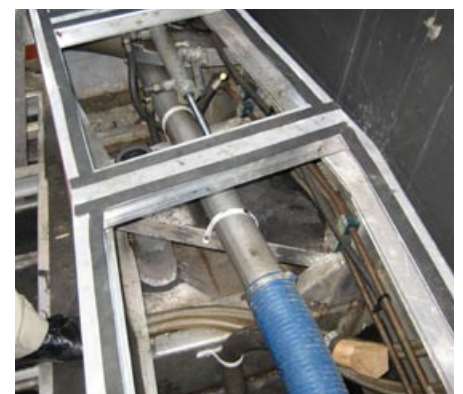
I de centrala delarna av bilden syns hjärtstocken och skadan i skrovgenomföringen.
