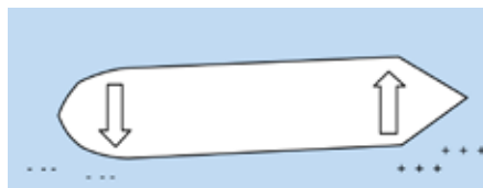
Illustration av bankeffekt i vid framfart i en trång farled. Plustecknen visar övertrycket och minustecknen undertrycket som bildas. Pilarna visar krafterna i sidled som på verkar fartyget.
