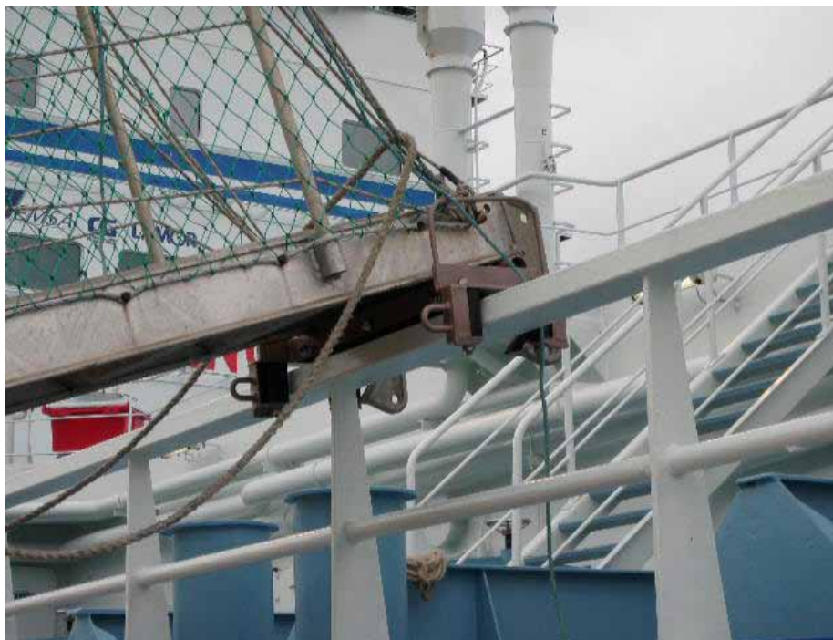
Två hjulförsedda landgångsvagnar underlättar arbetet på tankfartyget M/T Tellus.
