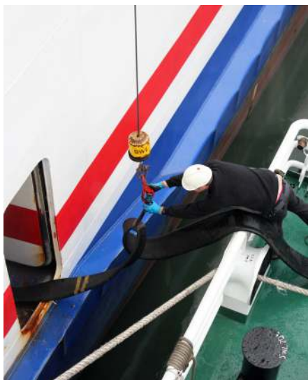
Läktringsslangen krokas fast för att lyftas.
