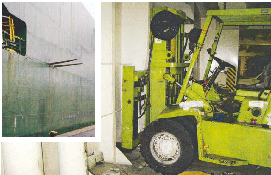
Trucken på bilden har kört gafflarna genom skrovsidan.
