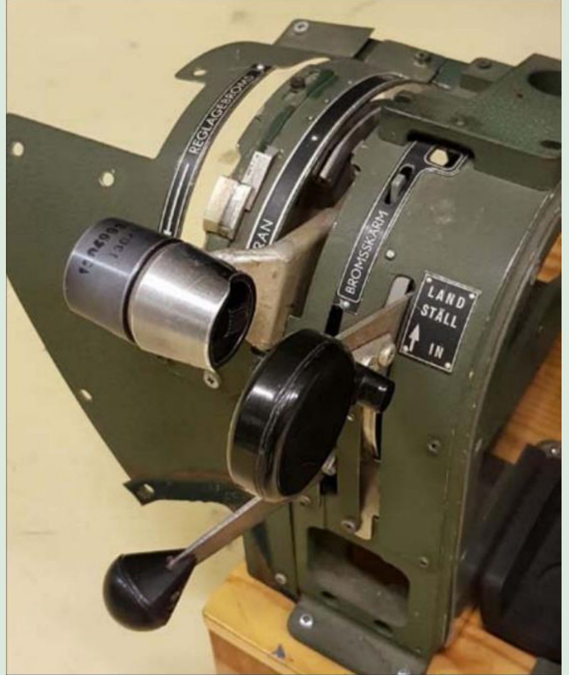
Gasreglage och landställsreglage satt nära.
