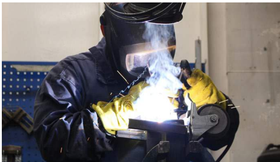
Skyddsutrustning och punktugus minskar risken att utsättas för skadliga ämnen i samband med svetsning.
